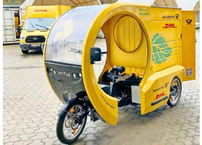
**Die vorletzte und die letzte Meile werden grün: Im Rahmen des Feldversuchs „DECARBOMILE“ wird in Hamburg ein Elektro-Boot mit Paketen beladen, um diese an das Alsterfleet zu bringen (links). Dort werden die Sendungen dann in elektrischen Lastenrädern verstaut und emissionsfrei zugestellt (rechts).**
