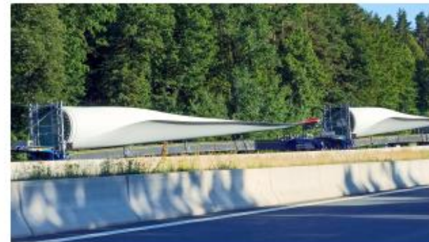
Rotorblätter wie diese müssen mit speziellen Schwerlasttransporten durch Deutschland transportiert werden. © Smith/imagio images
